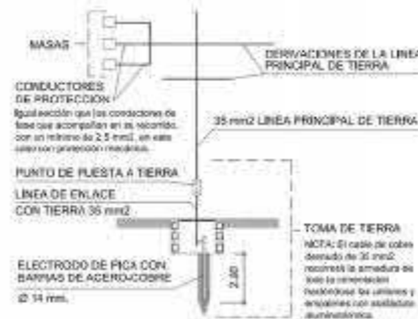
ESQUEMA DE PUESTA A TIERRA
